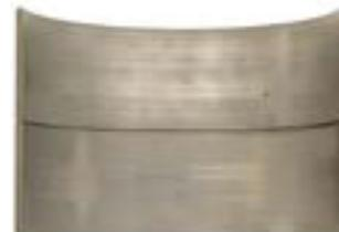
I cuscinetti della biella hanno visto meno del 5 percento del loro rivestimento rimosso e lo 0 percento del rame esposto, dimostrando un'eccellente protezione contro usura e corrosione in presenza di contaminanti corrosivi del gas combustibile.
