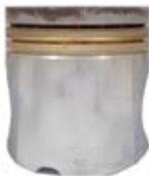
Il gruppo cilindri di alimentazione presentava minimi depositi di carbonio, vernici e lacche sul colletto dei pistoni e nelle scanalature.
