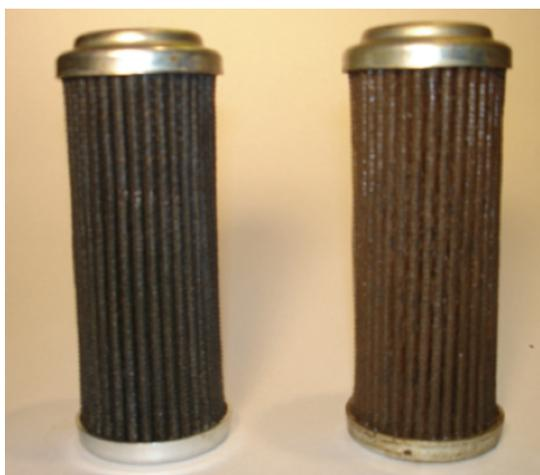
Filtri idraulici puliti vs. sporchi
